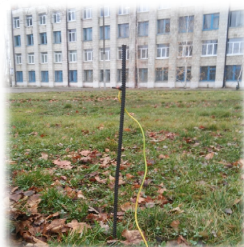
Рис. 1. Лабораторная установка, измерения сопротивления от влажности грунта
